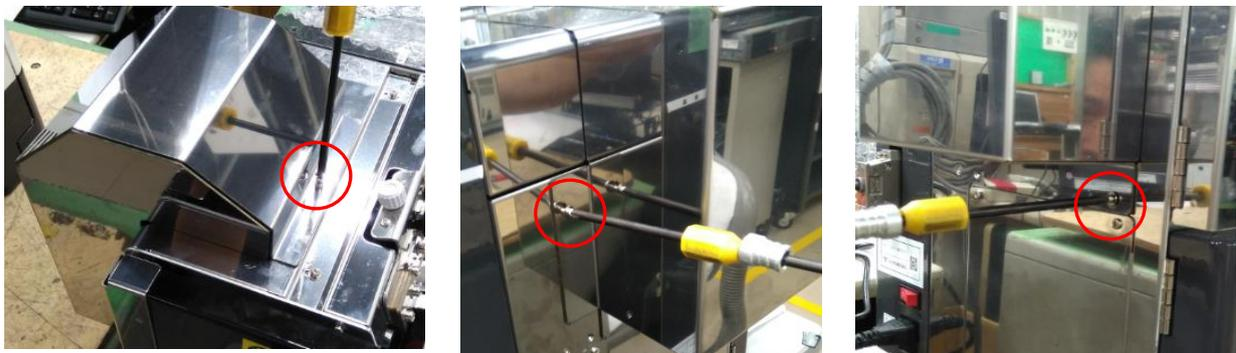
⑥で外した箇所全てで、付属のWバインド M3×8mmネジを用いて固定します。
