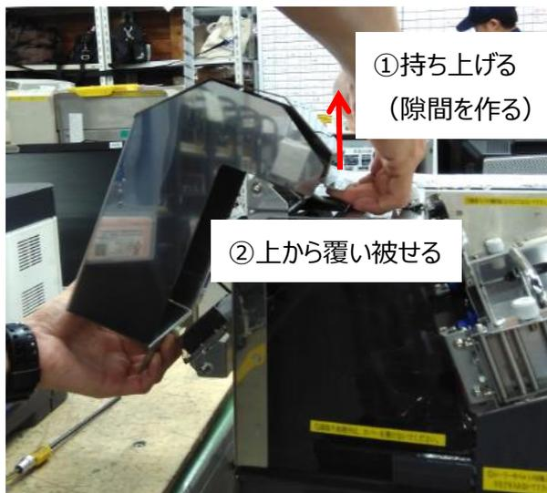
遮光カバー上部を持ち上げて、機台の上側のスキャナを覆うように取り付けます。
