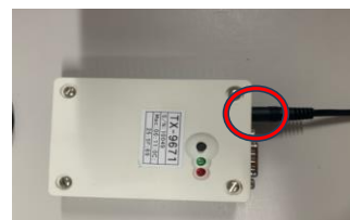
TX9671電源ケーブル
