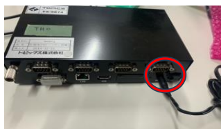
TX9674電源ケーブル
